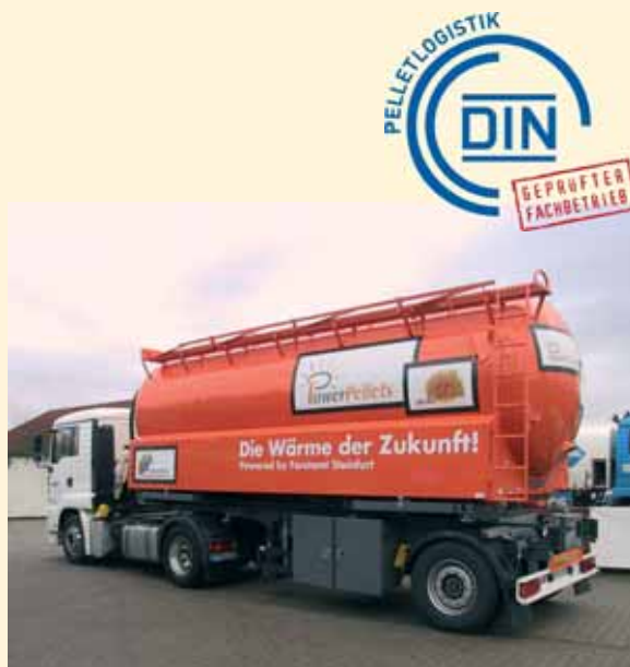
Holzpellets werden mittels Tankfahrzeug angeliefert Foto: Ahlert Junior, Greven,
