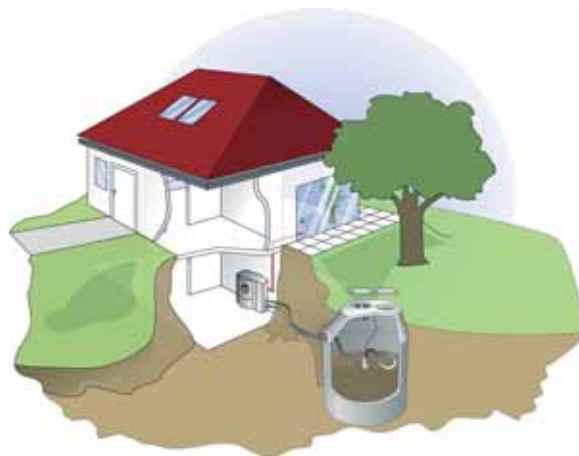
Beispiel für einen Pelletlagertank außerhalb des Hauses. Die Pelletförderung erfolgt durch Saugausstragung. Grafik: Mall GmbH, Donaueschingen
